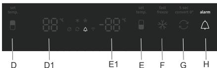
Bei überhöhter Temperatur im Geräteinneren wird ein unterbrochenes akustisches Signal ausgelöst .
