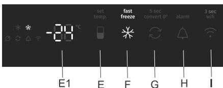
**Einschalten:** Schalten Sie das intensive Einfrieren durch Drücken der Taste **F** ein. Sie hören einen Piepton und das Display **super freeze** leuchtet auf.
